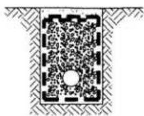
۶- اجرای خاکریز باقیمانده روی کانال و تراکم
