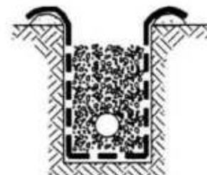
۴- ریختن مصالح زهکشی و تراکم
