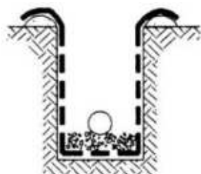
۳- اجرای مصالح زیرین و نصب لوله
