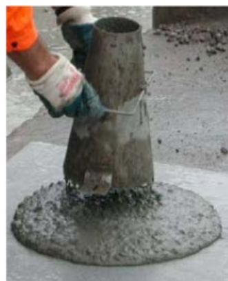
شکل ۲-۳ انجام آزمایش جریان اسلامپ
